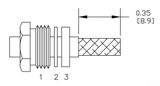
FORM BRAID OVER CLAMP NUT (4). TRIM BRAID BACK TO SHOULDER. CUT DIELECTRIC & CENTER CONDUCTOR TO DIMENSION SHOWN. DO NOT NICK CENTER CONDUCTOR, SOLDER CONTACT TO CENTER CONDUCTOR. REMOVE EXCESS SOLDER. DO NOT OVER HEAT DIELECTRIC, INSERT CABLE ASSEMBLY INTO BODY & TIGHTEN.
