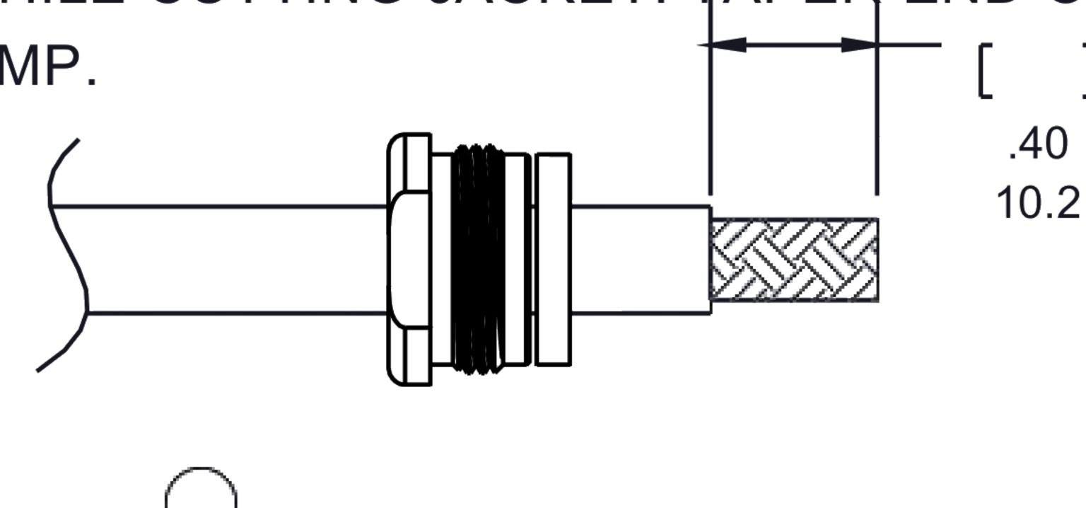
2. SLIDE BRAID CLAMP 3 OVER BRAID & SEAT AGAINST CABLE. FORM BRAID OVER CLAMP NUT. TRIM BRAID BACK TO SHOULDER. CUT DIELECTRIC TO DIMENSION SHOWN. DO NOT NICK CENTER CONDUCTOR.
