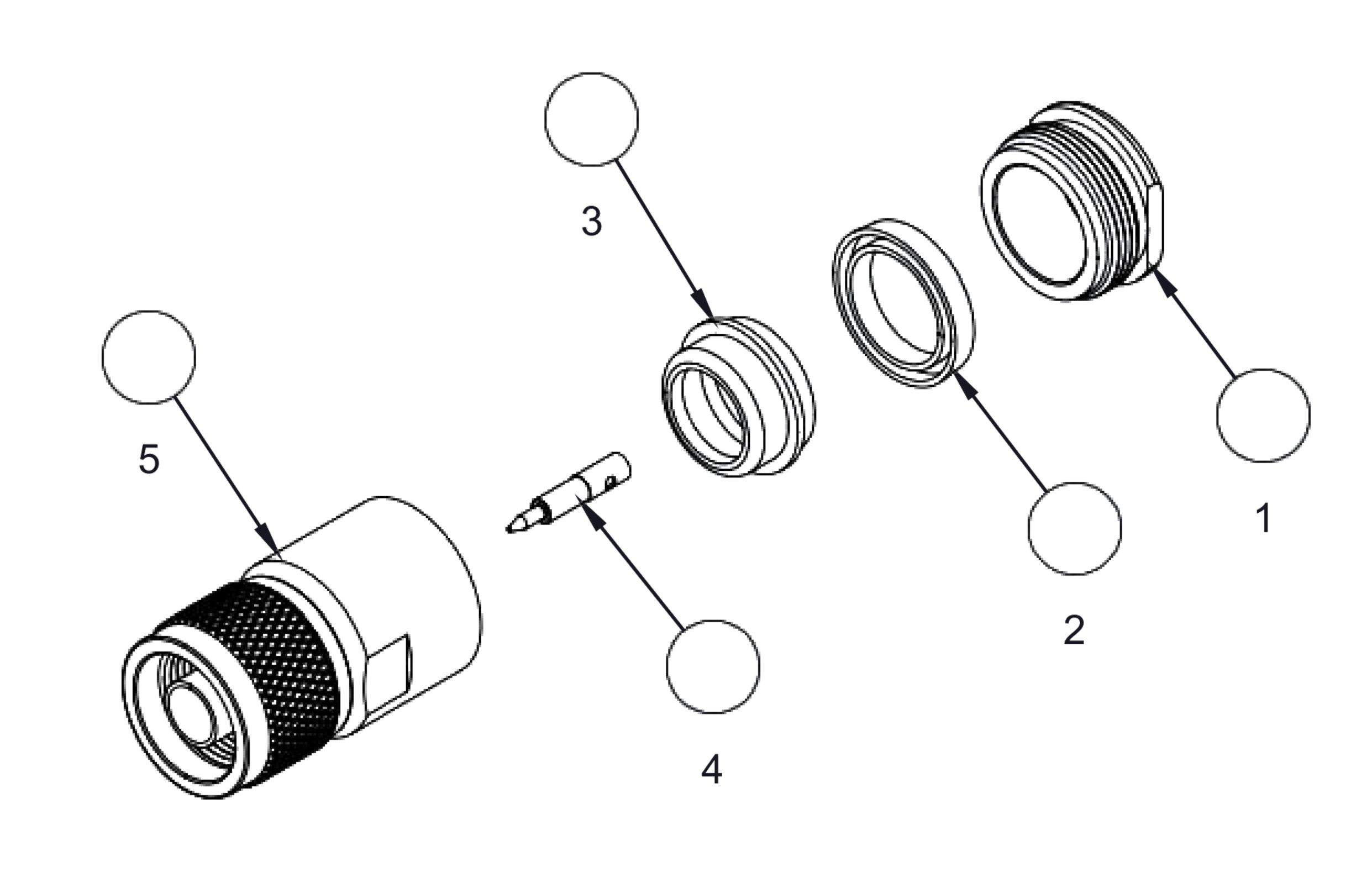
1. SLIDE CLAMP NUT 1 & GASKET 2 OVER CABLE. STRIP CABLE AS SHOWN. DO NOT NICK BRAID WHILE CUTTING JACKET. TAPER END OF BRAID TO PERMIT ASSEMBLY OF CLAMP.
