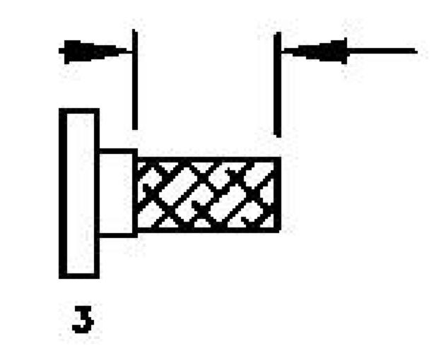
BRAID CU\MP (4). SLIDE BRAID CLAMP (4) OVER BRAID & SEAT AGAINST CABLE. .325
