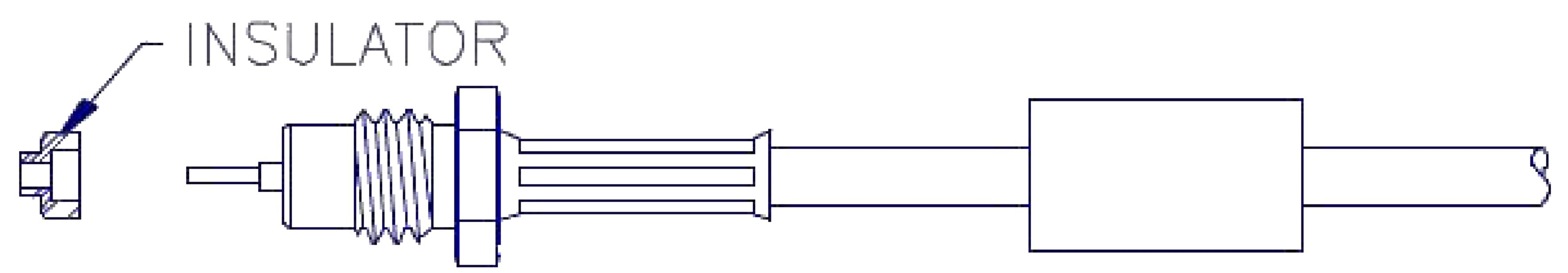
6. POSITION INSULATOR OVER CABLE DIELECTIC AND CENTER CONDUCTOR.
