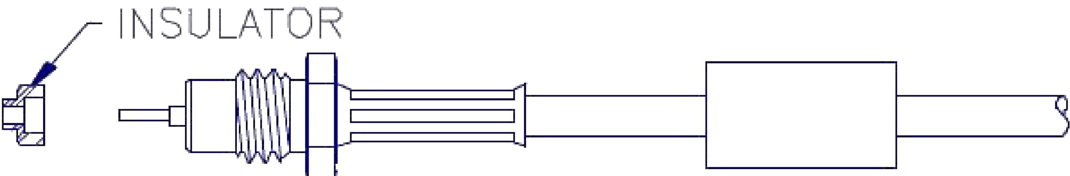
6. POSITION INSULATOR OVER CABLE DIELECTIC AND CENTER CONDUCTOR.
